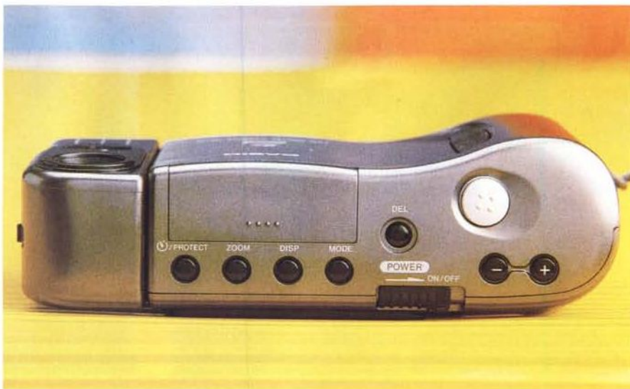
Sul lato superiore troviamo tutti i comandi dell'apparecchio e le interfacce analogica e digitale della fotocamera.
